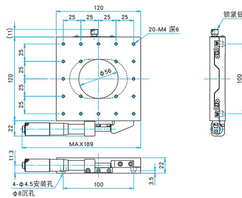
**TSD-1201CH-M6/1201CHUU** 内六角螺栓 M6×8...4个 (M6)
